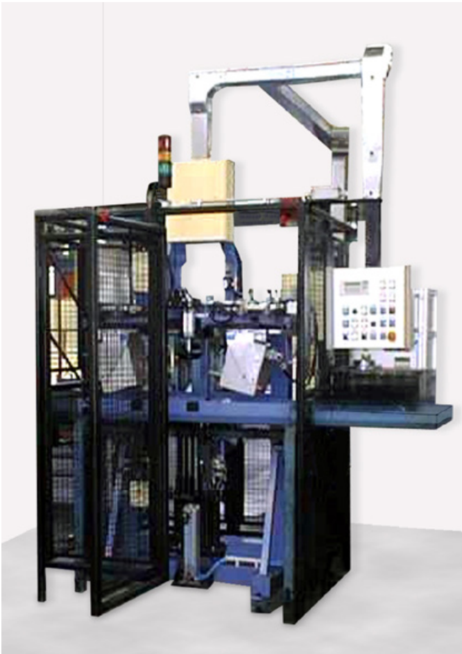
Dispositivo centratore e gruppi di micropunzonatura
