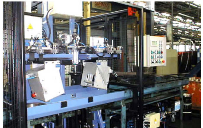
Dispositivo centratore e gruppi di micropunzonatura
